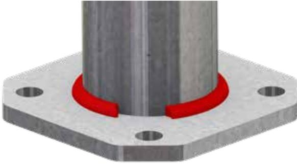
Soudure partiellement absente ou endommagée
